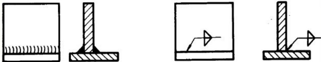
图7-35 对称焊缝（角焊缝）标注
